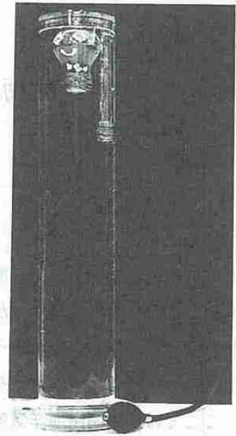
図4 浮沈子実験装置
