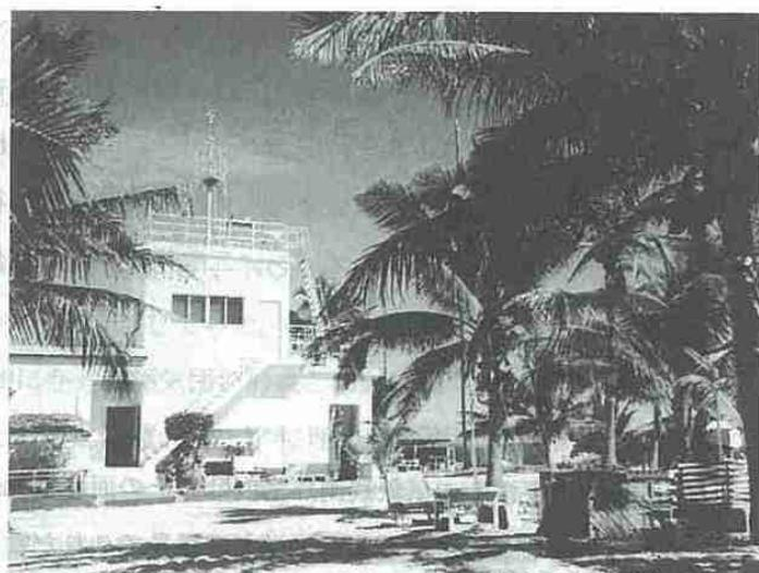
写真3 気象観測所庁舎。屋上に測風塔、日射計がある。
